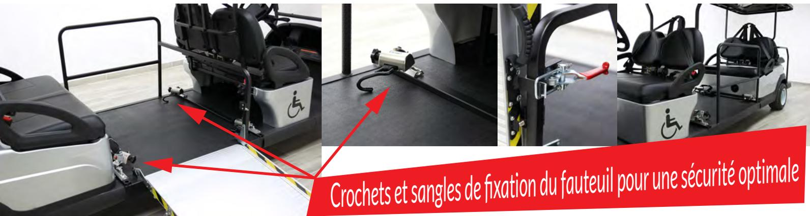
*Crochets et sangles de fixation du fauteuil pour une sécurité optimale*
